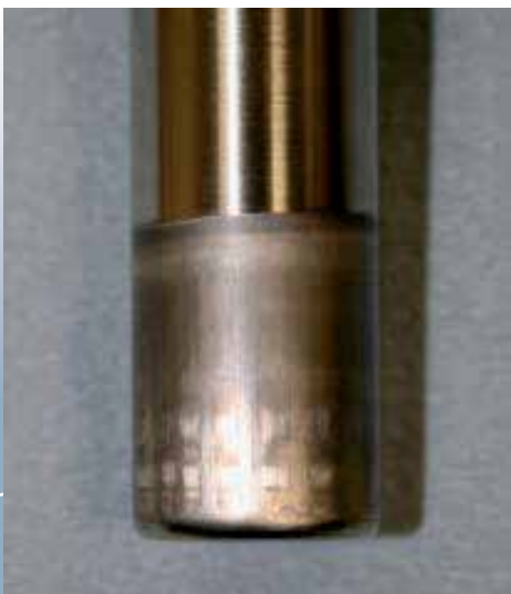
Oberfläche der Tiefziehstempel nach 58000 (links unbeschichtet) und 196000 (rechts TiCN-beschichtet) Tiefzierteilen
