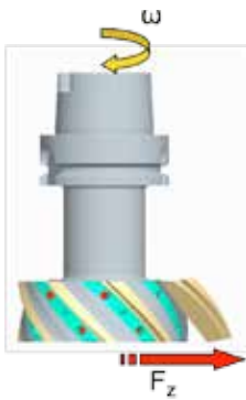
FEM-Modell des Schneidwerkzeugs
