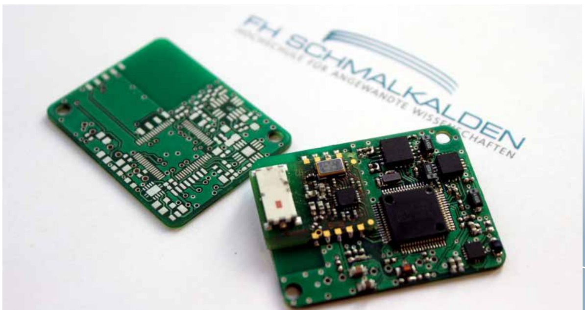
Drahtlose Sensoren mit integrierter Datenverarbeitung für die Gestenerkennung
