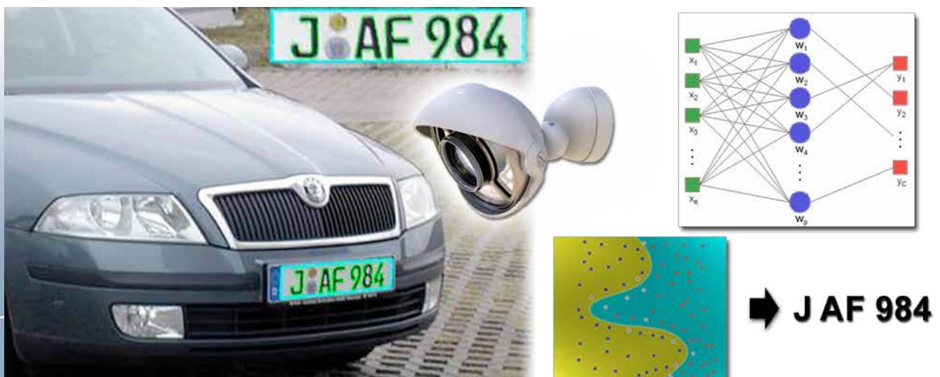
Kamera mit eingebetteter Intelligenz für die Kennzeichenerkennung
